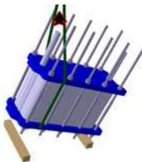
**6** dovesti izmenjivač toplote u vertikalni položaj i polako ga spustiti na podlogu
